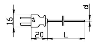
CHEMICAL RESISTANCE THERMOCOUPLE 防化學腐蝕熱電隅
